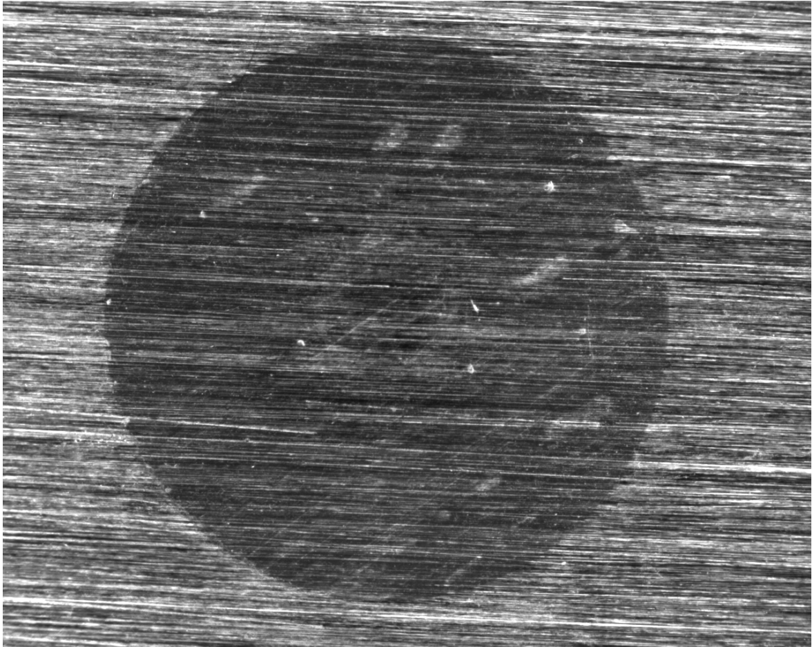
Abbildung 25: Abdruck mit stark Form-überlagernden Schleifspuren
